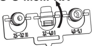
Je nach Kabeldurchmesser, benötigte Dichtung ausbrechen.
