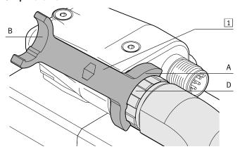
• Расположите инструмент 1 с соответствующим вилочным захватом (A)/(B) на винтовом фиксаторе (D).
